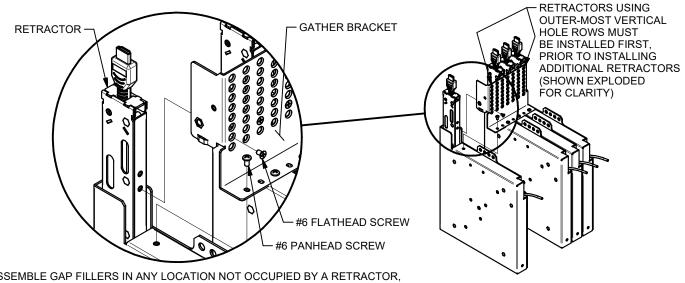
1b. ASSEMBLE GAP FILLERS IN ANY LOCATION NOT OCCUPIED BY A RETRACTOR, AT THE DESIRED HEIGHT.
