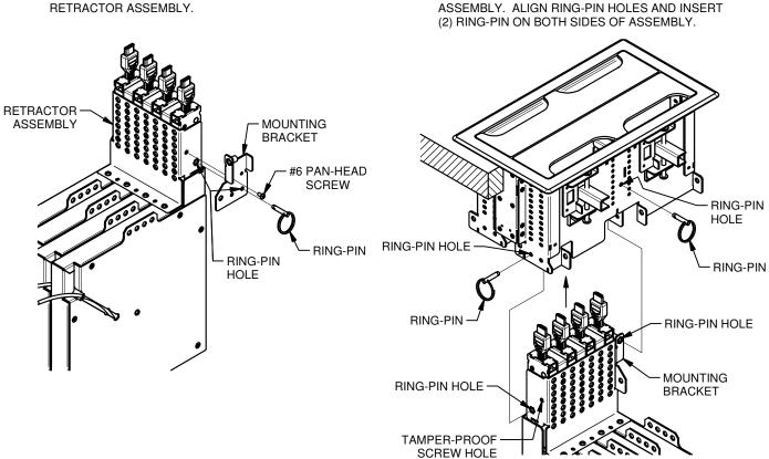
LS-2. SLIDE RETRACTOR ASSEMBLY INTO RT6-RD4
