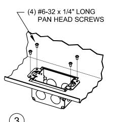
INSTALL SWITCH-BOX FROM THE INSIDE OF WALL BOX WITH THE SUPPLIED SCREWS
