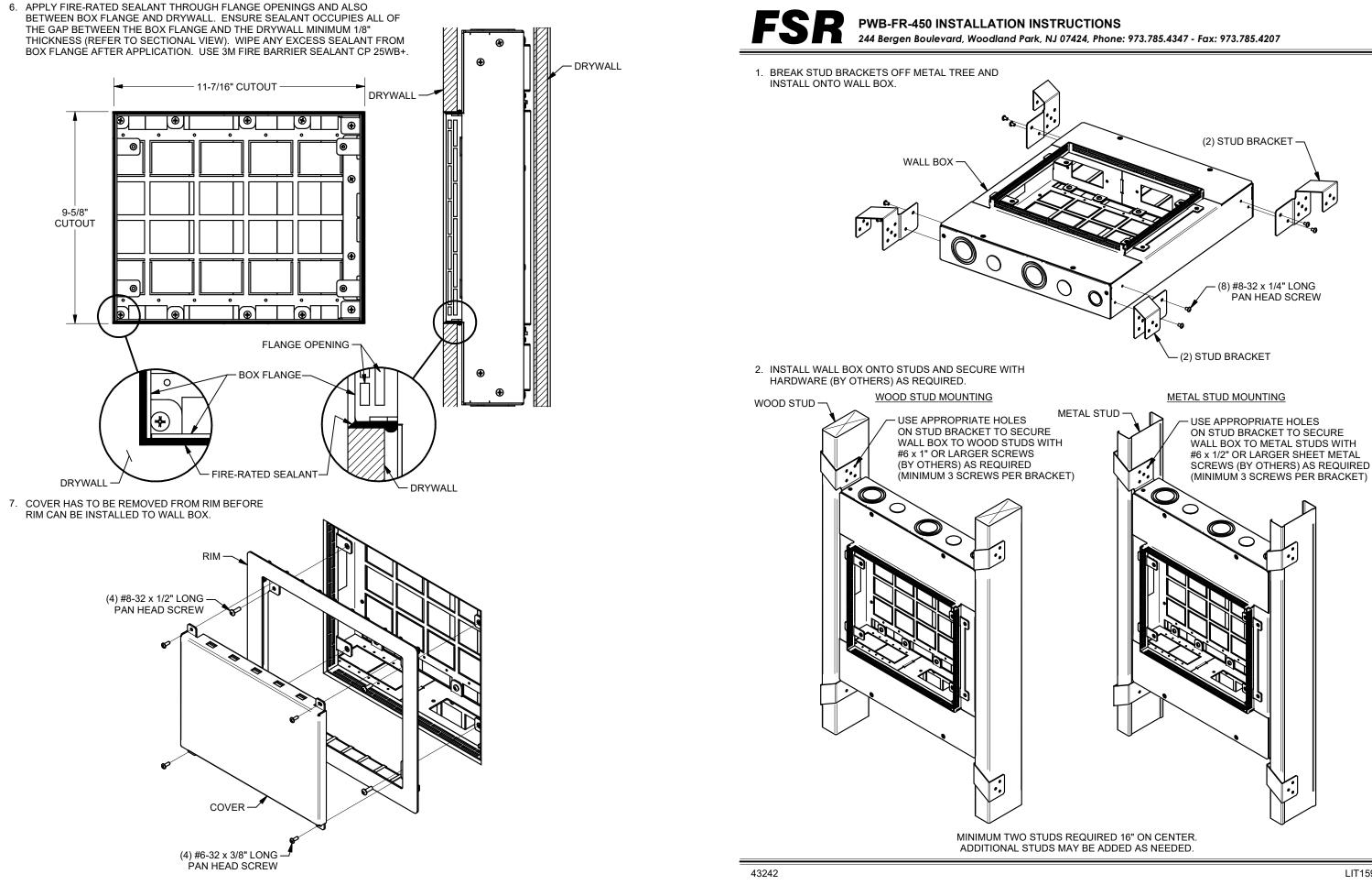
3. REMOVE BACKBOX COVERS AND ROUTE CONDUITS TO WALL BOX AS REQUIRED.
