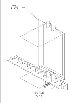
3. INSERT WALL PLATES  $\mathsf{AND}$ TIGHTEN SCREWS AS NECESSARY
